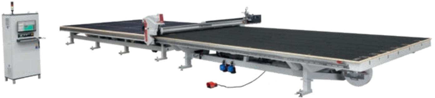
Genius CT-LINE es la mesa de corte en la versión con correas, que se ha diseñado para aumentar el rendimiento en configuraciones de línea o planta en las que se contempla la integración con carga automática y mesa de corte.
