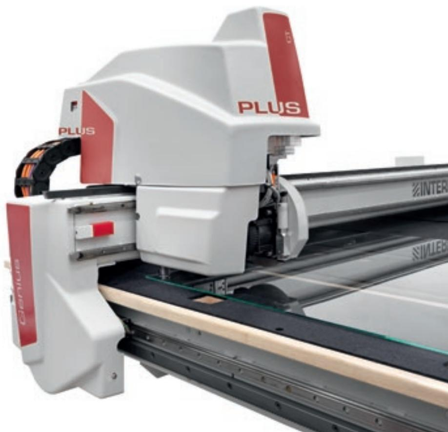
Las patas automáticas funcionan como apoyo de la placa durante el basculamiento de la mesa y, si es necesario, como alineadores mecánicos de la placa.
