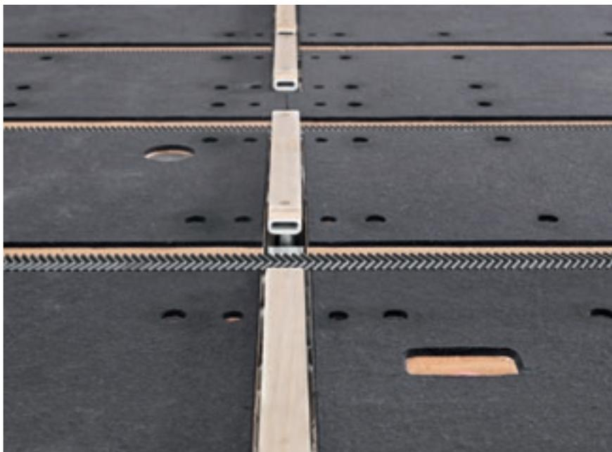
El sistema integrado de correas permite trasladar la placa fácilmente a la línea.
