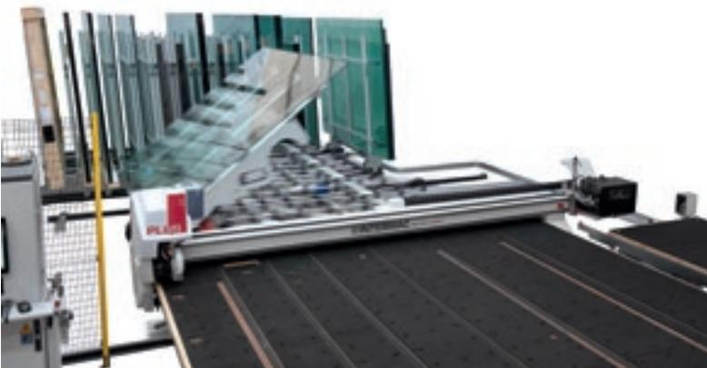
Las soluciones independientes o en línea automatizada se rigen por un software de optimización de procesos y dan como resultado una gama completa que incluye los sistemas inteligentes de almacenamiento y manipulación Movetro integrados con la gama de bancos de corte Intermac Genius.
