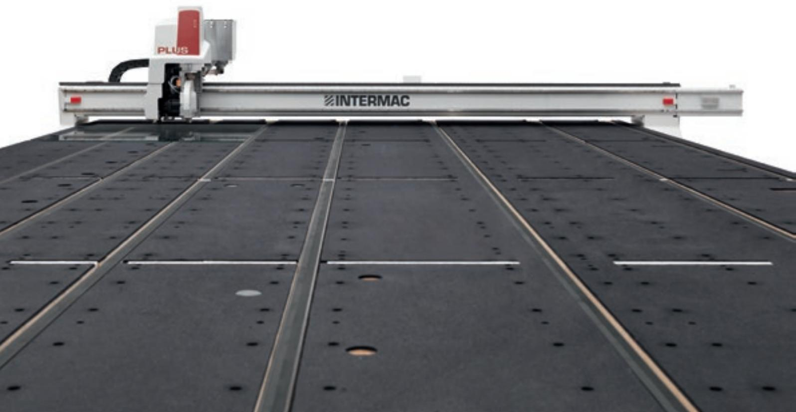
La base de la máquina está formada por una estructura rígida y rectificadas sobre la cual se aplican paneles de madera rectificadas que garantizan la máxima planaridad de la zona de trabajo, una condición necesaria para lograr un grabado y un tronzado del vidrio excelentes.
